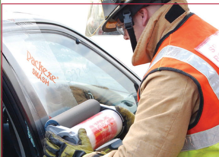
Láminas autoadhesivas para tratamiento del cristal durante la extricación de vehículos.
