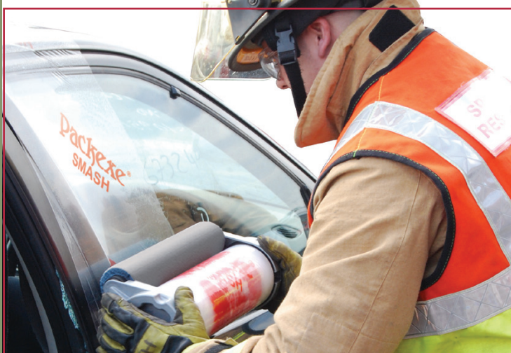
Películas auto-adesivas para tratamento de vidros durante o desencarceramento de veículos.
