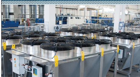
Condensador con intercambiador 100% en aluminio, con -80% de carga de refrigerante en comparación con las baterías tradicionales, -40% de promedio como gastos energéticos
