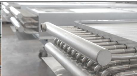
Baterías de tubo acero inoxidable 204 o 316L. Soldadura con gas inerte y pasivación para eliminar riesgo de corrosión
