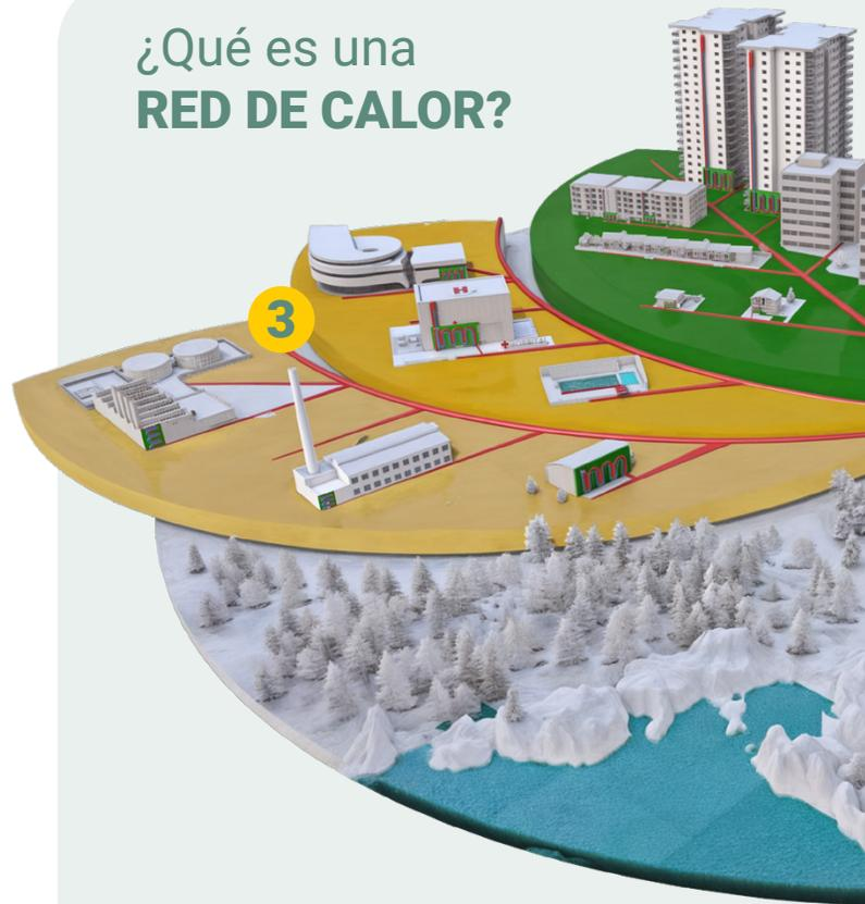
Sistema urbano de calefacción y agua caliente que solamente utiliza **Energías Renovables**. Gracias a esta infraestructura, se centraliza la producción de la energía (agua caliente a 95°) en la **Central Térmica (1)**.
