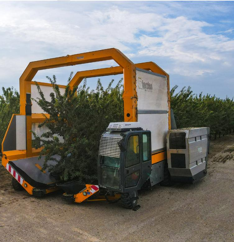
La máquina recolectora de almendra y pistacho **Tenías Harvester** es un sistema de recolección en continuo que, gracias a su sistema de vibrado completamente automático, logra optimizar el proceso de recolección.
